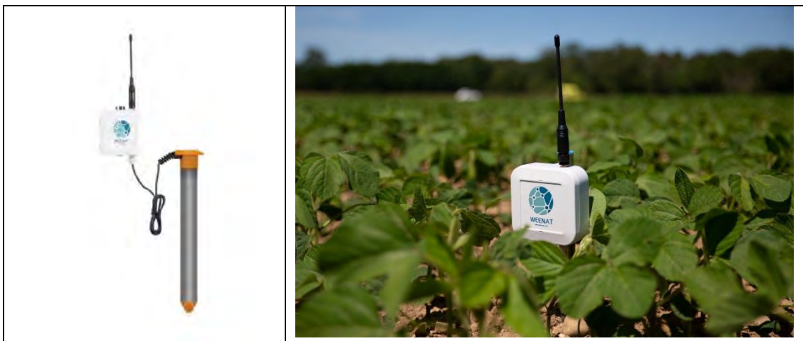
Sonde capacitive « Weenat » utilisée par Mme POUYSEGUR
